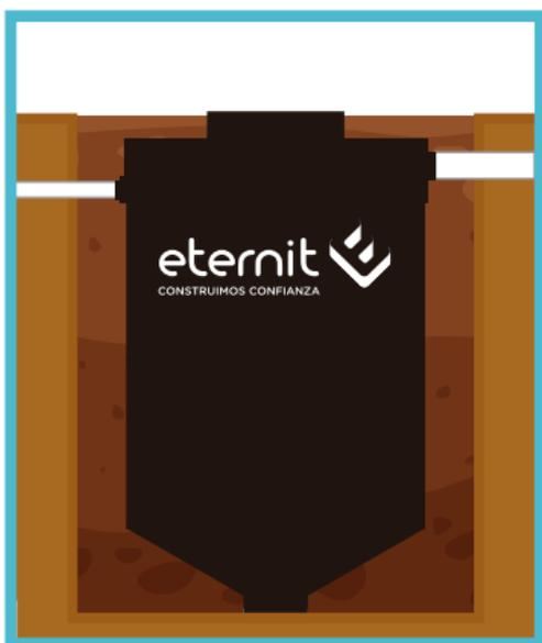
Después de realizar todas las conexiones de la vivienda hacia el biodigestor y después de haberlo llenado con agua, se procederá a terminar de enterrar el biodigestor. El material utilizado debe ser zarandeado.
