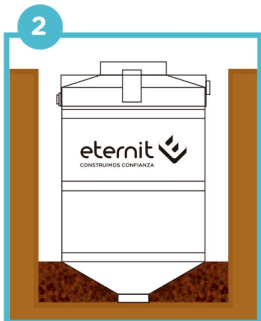
Colocar el biodigestor con cuidado en el hoyo excavado, nivelándolo horizontalmente antes de continuar con su instalación.
